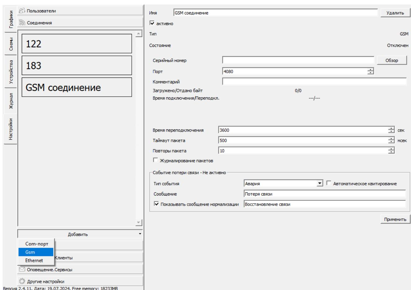
Рисунок 42 – Создание GSM соединения
