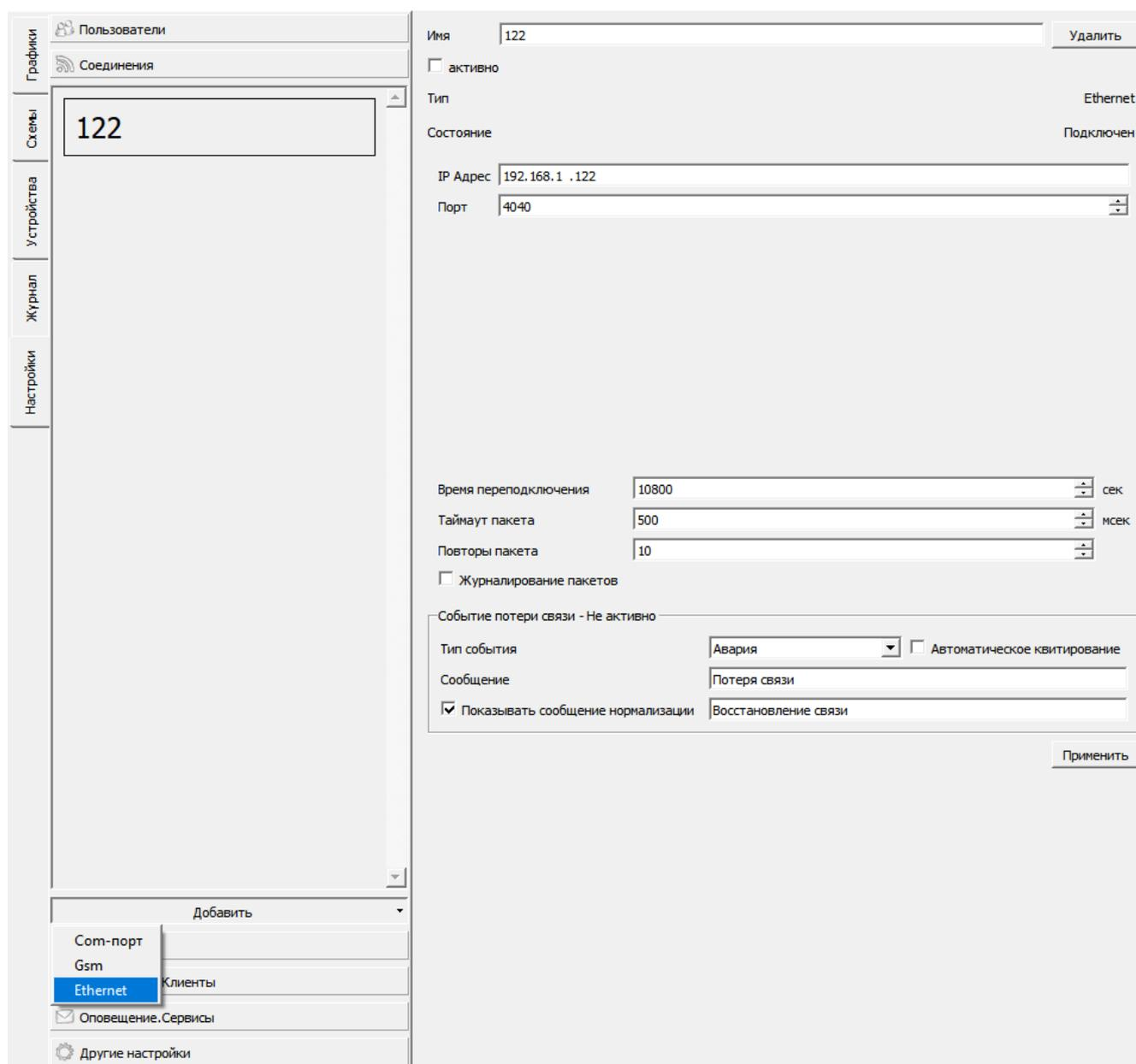
Рисунок 40 – Создание Ethernet соединения
