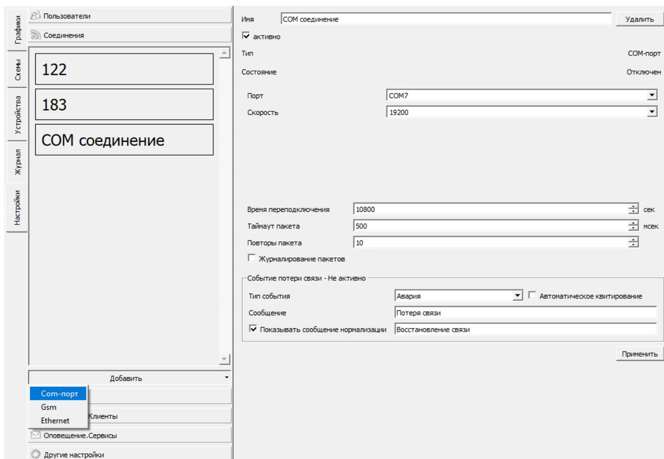
Рисунок 41 – Создание COM-порт соединения
