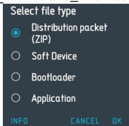
Установка начнется сразу после выбора архива с прошивкой. Прибор автоматически перезагрузится после обновления микропрограммы.
