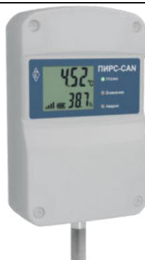
Датчик ИПМ-12-20-4-2 встроенный в проводной узел ПИРС-CAN
