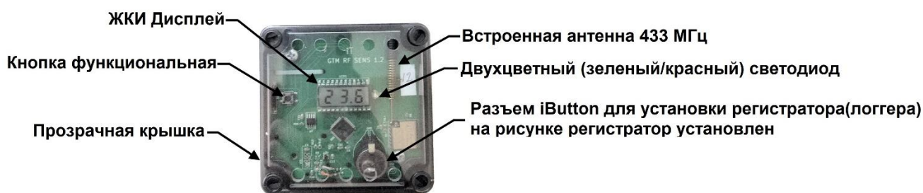
Рисунок 1 – Вид беспроводного узла I-Sens
