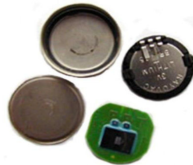
Рисунок 3 – Устройство регистратора серии TR
