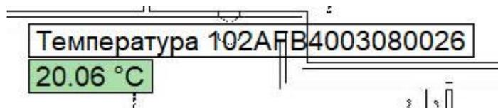
Рисунок 16 – Обозначение датчика на схеме
