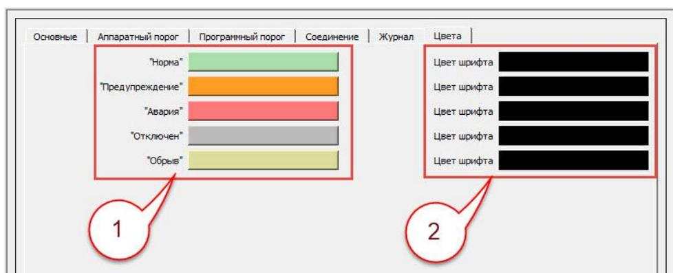
Рисунок 29 – Параметры датчика, вкладка «Цвета»
