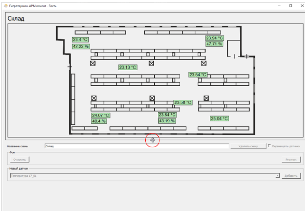
Рисунок 16 – Вертикальный курсор-расширитель на вкладке «Схемы»
