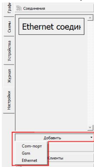
Рисунок 5 – Добавление нового соединения
