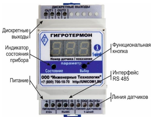
Рисунок 1 – Вид панели прибора с обозначением входов/выходов
