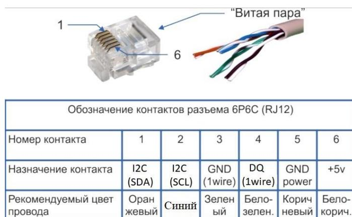
Рисунок 2 – Схема подключения выносного элемента
