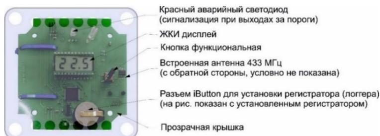
Рисунок 1 – Вид беспроводного узла I-Sens с элементами подключения и индикации
